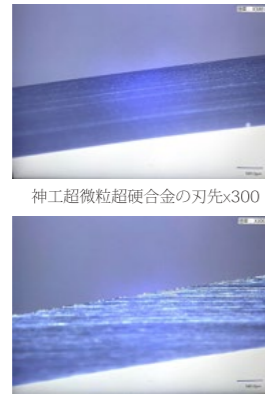
通常の細粒超硬合金の刃先x300
