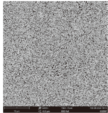
神工超微粒超硬合金の刃先x300
