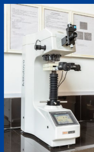
日本Mitutoyo维氏Hv硬度计 (可同时测量断裂韧性K1c)
